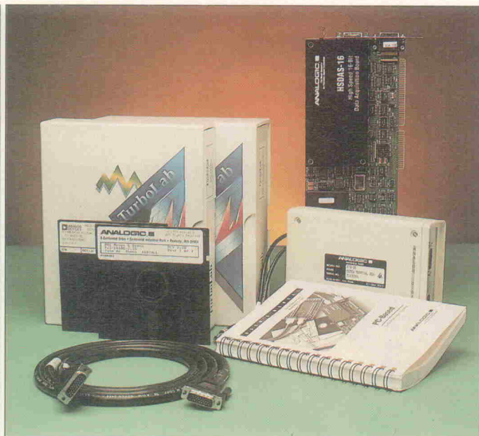
Bild 1. Die HSDAS-16 bietet passend zur hohen Abtastrate DMA-Transfer und FIFO-Speicher.
