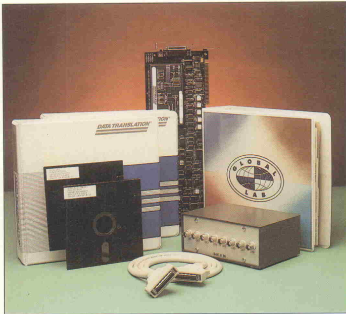
Bild 5. Acht Digitalports auf der DT 2838 lassen sich als einzelne Ein- oder Ausgänge nutzen.
